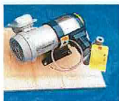
交換用PAC注入ポンプ
