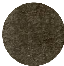
使用済みフィルター 砂ぼこり、虫などで目詰まりしている
